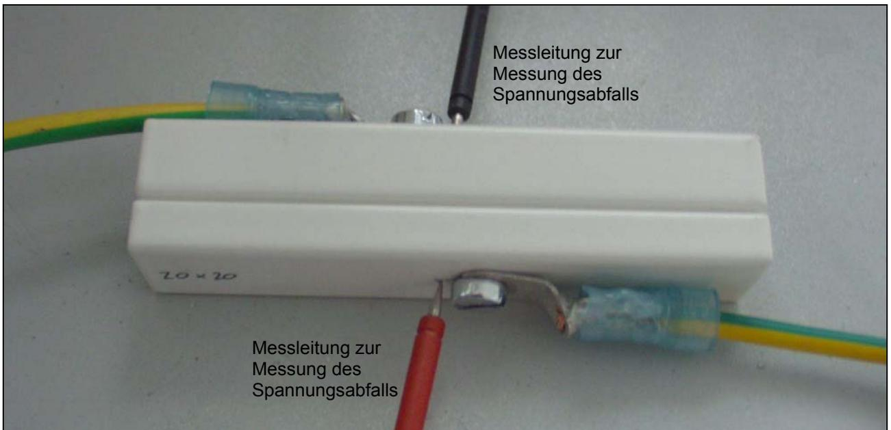
Bild A2: Prüfaufbau inklusive Messanordnung am Beispiel des LKM 20020 mit Farbbeschichtung
